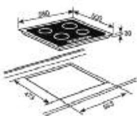
Position Anschlusskasten HM (Tiefe 50 mm)
